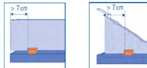
Омоноличивание профиля может производиться не ранее чем через 1 час после его монтажа на пасту MasterSeal 912 (данные для t воздуха 20 °C).
