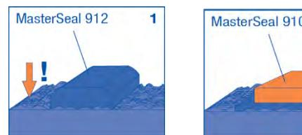
После установки MasterSeal 910 зона шва должна содержаться чистой, без свободных частиц и грязи до бетонирования.
