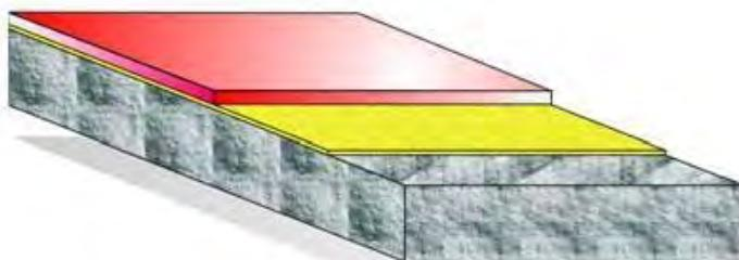
Применяется в закрытых помещениях или на улице с перепадами температур и «сухими» и «влажными» производственными процессами. Повышенная стойкость к абразивным и ударным воздействиям. Температурная стойкость от -25 до +80°C.
